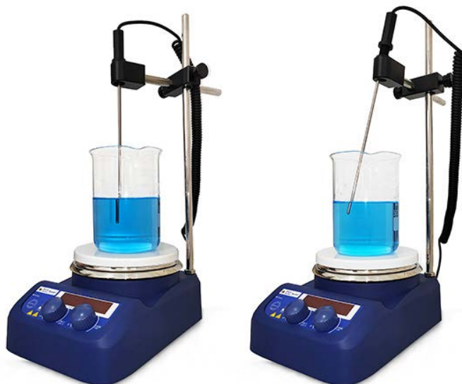
图3. BeyoStir™数字加热型磁力搅拌器(5L,含温度传感器) (E6745)的温度传感器使用示意图。横杆的支架孔两侧分别为螺纹和光面，螺纹一侧可用于安装标配温度传感器，使用时将温度传感器直接旋紧即可(左图)；或将中空橡胶塞放入光面一侧，然后将温度传感器探头直接架在中空橡胶塞中进行温度检测，即临时搭载温度传感器(右图)。
